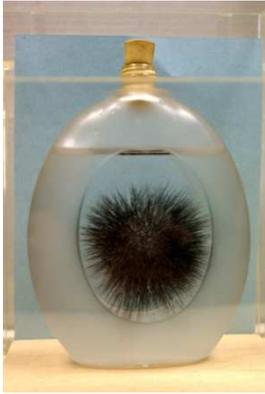
1. En un frasco que contiene aceite para bebés se han vertido limaduras de acero. Se agita el frasco y se coloca en un recipiente que contiene un imán. Se observa cómo las limaduras se orientan siguiendo la dirección de las líneas de inducción magnética producidas por el imán.
